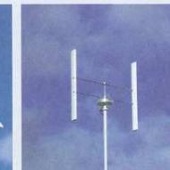
5 kW Anlage Nennleistung: 5,0 kW Rotordurchmesser: 5,2 m
