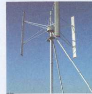
40 kW Anlage Nennleistung: 40,0 kW Rotordurchmesser: 12,0 m
