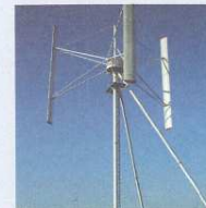
20 kW Anlage Nennleistung: 20,0 kW Rotordurchmesser: 6,0 m
