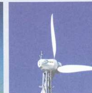
AIRCON 10 S Nennleistung: 9,8 kW Rotordurchmesser: 7,13 m
