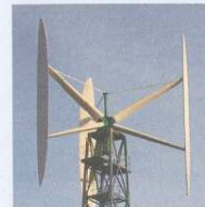
HEOS H50 Nennleistung: 50,0 kW Rotordurchmesser: 12,0 m
